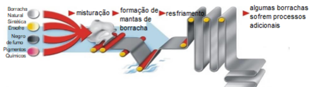
Figura 3 – Etapa de Fabricação do pneu: Misturação.
