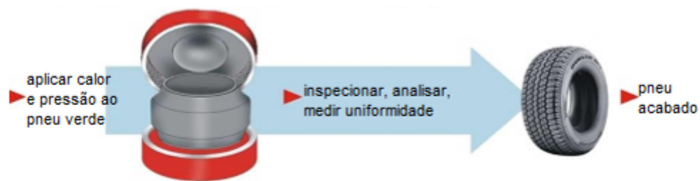
Figura 7 – Etapas de Fabricação do pneu: Vulcanização e Inspeção.
