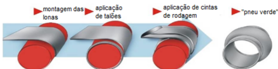
Figura 6 – Etapa de Fabricação do pneu: Construção.
