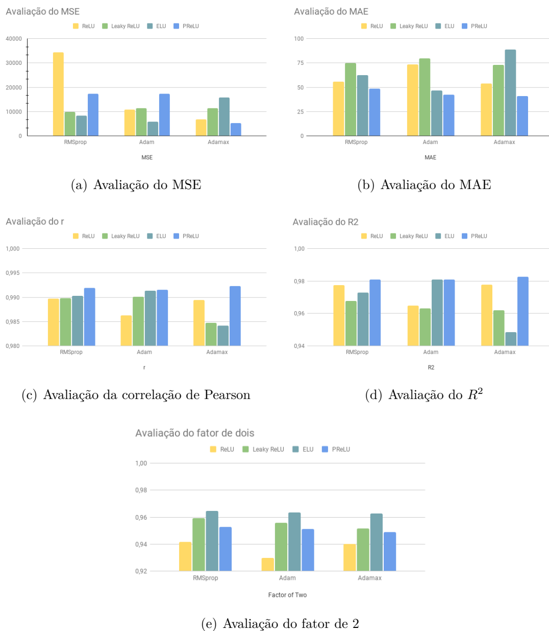
Figura 30 – Avaliação estatística das combinações das função de ativações e otimizadores para o (a) MSE, (b) MAE, (c) correlação de Pearson, (d) coeficiente de determinação R^2 e (e) fator de 2
