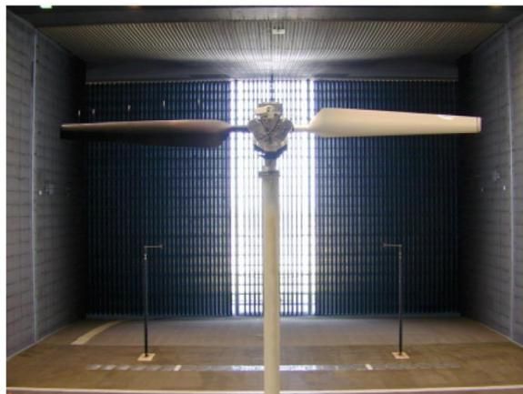
Figura 27: Turbina NREL Phase VI (Fonte: Hand et al., 2001).
