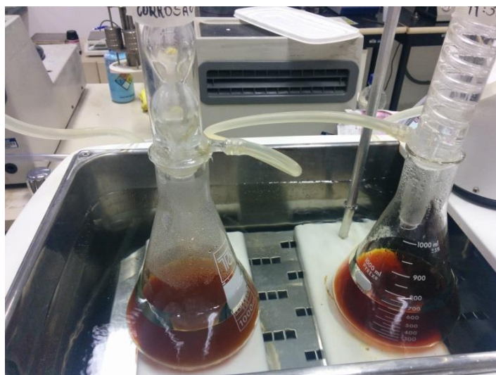
Figura 21 - Montagem experimental do ensaio de corrosão por imersão
