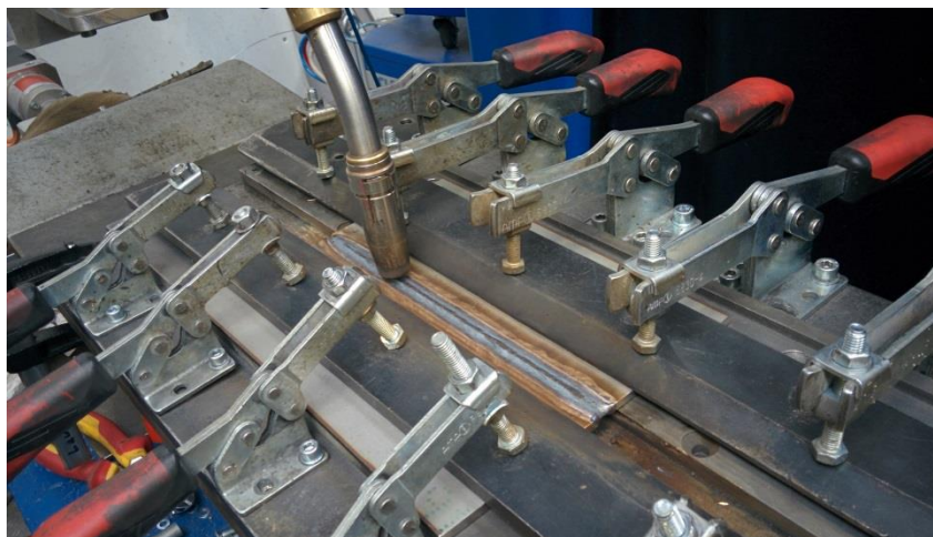
Figura 17 - Montagem experimental do processo de soldagem, detalhe do sistema de fixação da junta
