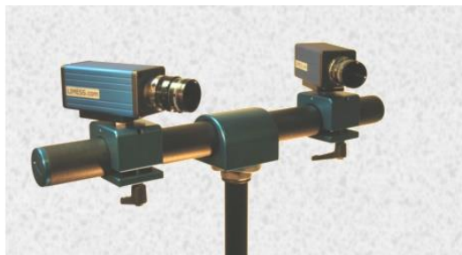
Figura 19 - Câmeras utilizadas para realização da técnica de Correlação de Imagens
