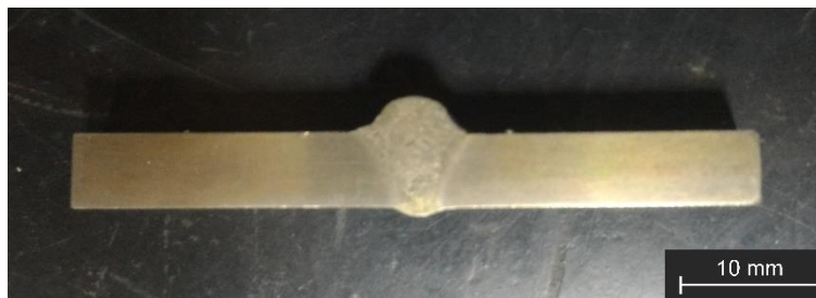
Figura 22 - Corpo de prova padrão para o ensaio de corrosão por imersão
