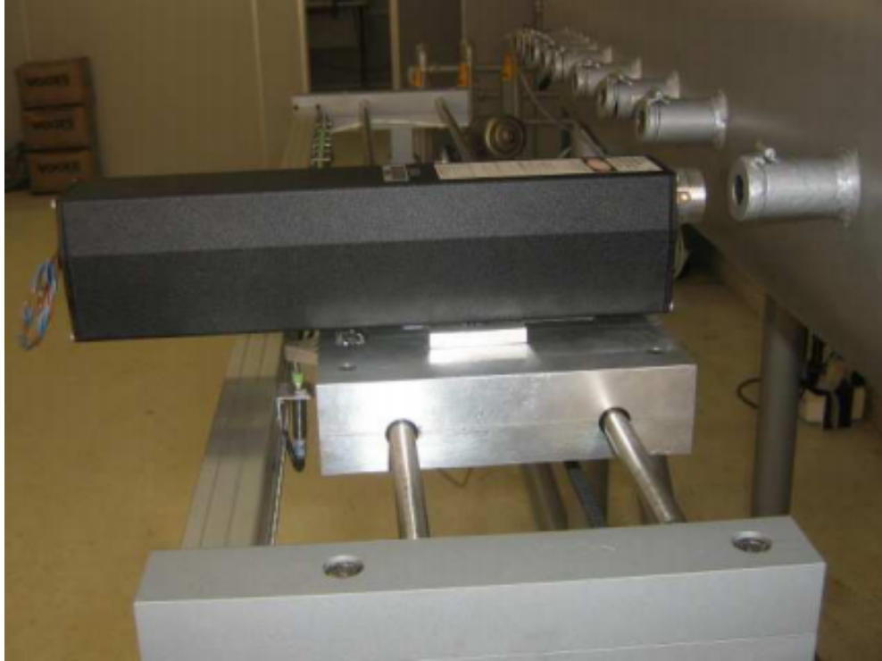
Figura 2.6: Vista do laser sobre a bancada em um sistema mecânico que permite uma medição automática dos 10 pontos (orifícios), (SANTOS, 2010).
