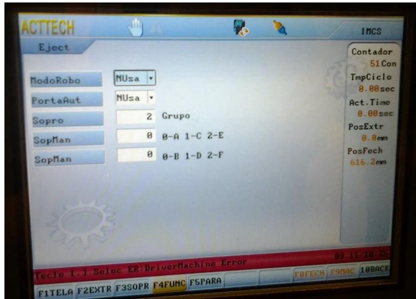
Figura 12 – Configuração da máquina para trabalhar com robô
