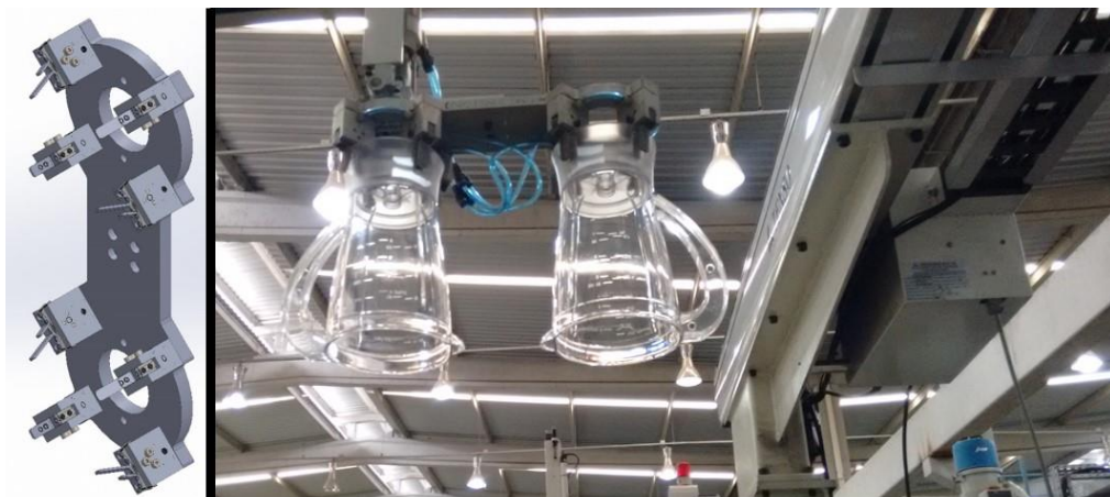
Figura 19 – Garra universal com pinça pneumática
