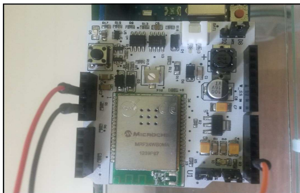
Figura 22 – Transmissores acoplados no processo e os cabos de interligação com o elemento sensor.
