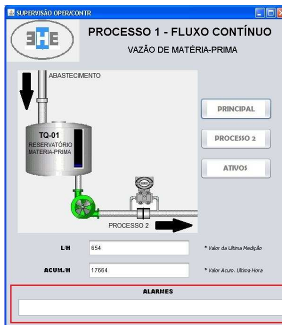
Figura 37 – Implantação de alarmes no sistema supervisorio como forma de melhoria.
