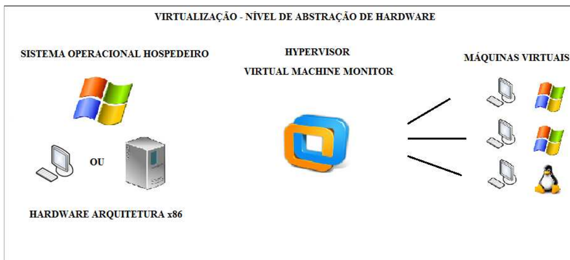
Figura 13 – Arquitetura simplificada de gerenciamento de máquinas virtuais.
