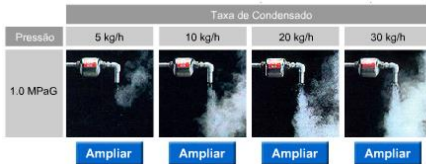
Figura 15 – Demonstração para análise de detecção de falhas ocultas. Fonte: http://www.tlv.com/global/BR/
