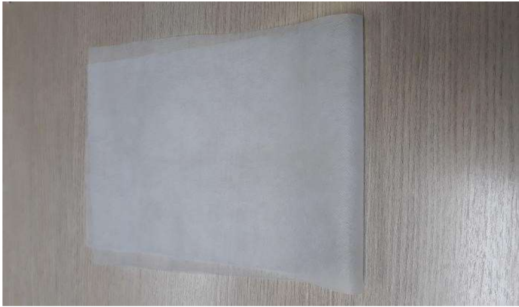
Figura 8. Tecido não tecido (TNT) de gramatura 40
