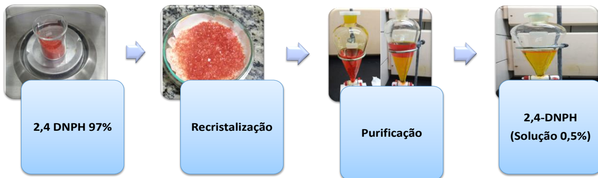
Figura 5- Etapas de preparo da solução de 2,4-DNPH.
