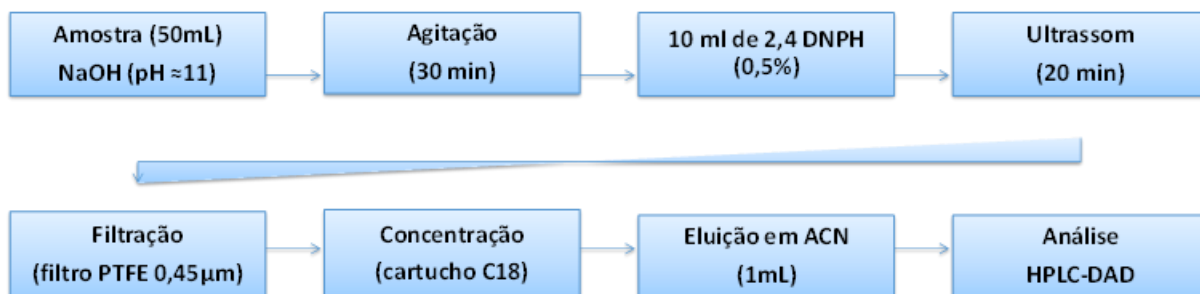
Figura 7-Análise de Compostos carbonílicos ligados – derivatização.
