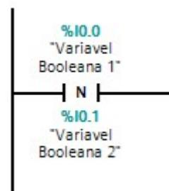
Figura 13 – Contato de detecção de borda de descida (BOTELHO, 2011)
