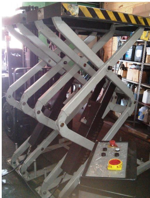
Figura 24 – Estrutura do elevador em tesoura
