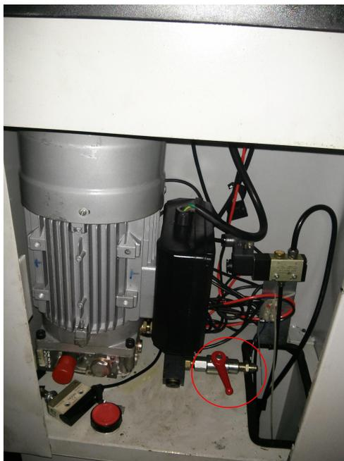
Figura 3 – Válvula de escape de ar para sincronia dos elevadores
