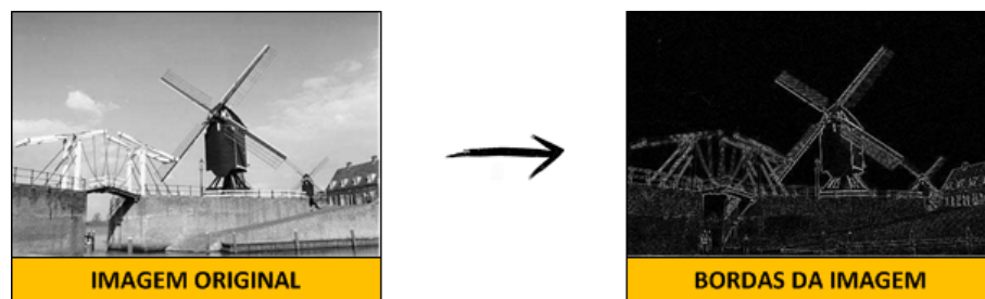
Figura 19 – Exemplo da aplicação de um algoritmo de detecção de bordas
