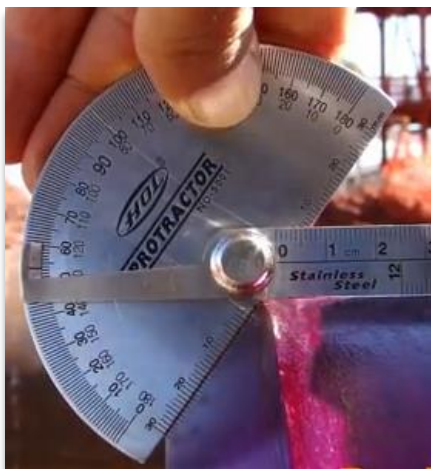
Figura 46 – Medida do ângulo do chanfro com uso do calibre de solda.
