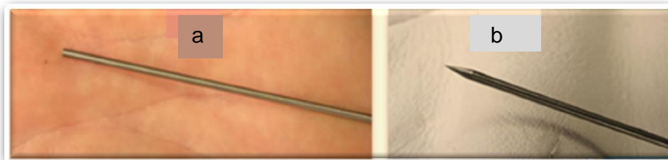
Figura 15 – (a) Eletrodo de tungstênio sem afiação. (b) Eletrodo de tungstênio devidamente afiado.
