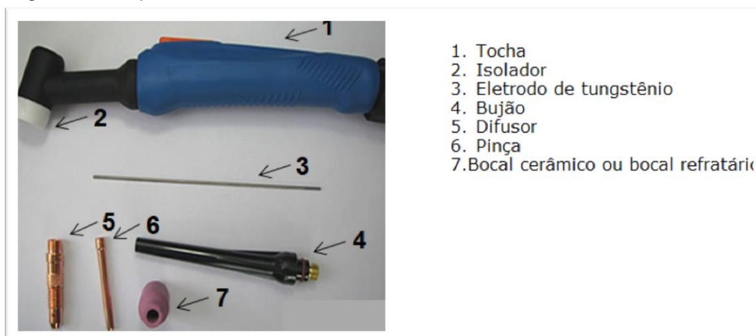
Figura 4 – Componentes da tocha TIG.
