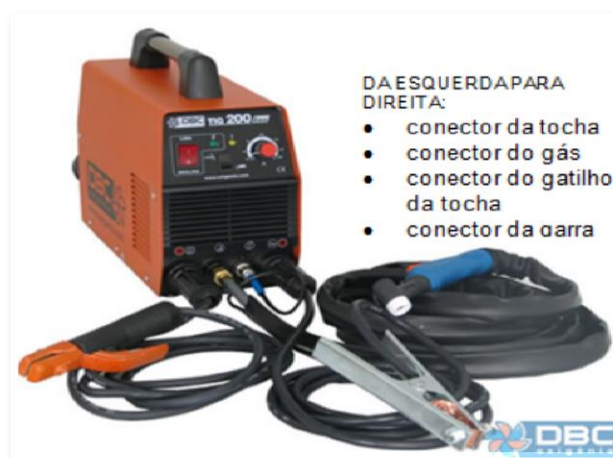
Figura 12 – Equipamento com os acessórios: porta eletrodo , garra e tocha TIG.
