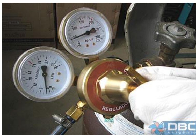
Figura 21 – Manômetro apresentando vazão e pressão no cilindro.
