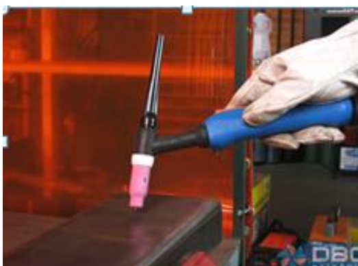
Figura 5 – Ângulo correto da tocha a aproximadamente 20 graus, com a purga do gás em direção à soldagem desejada.
