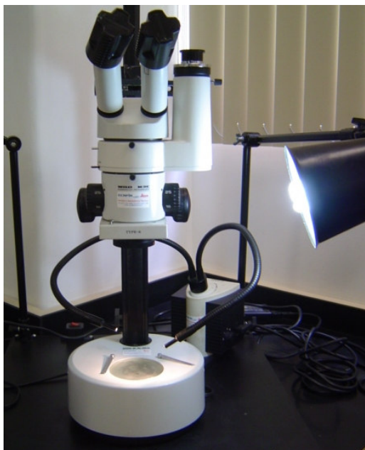
Figura 10 - Lupa estereoscópica usada na macrografia
