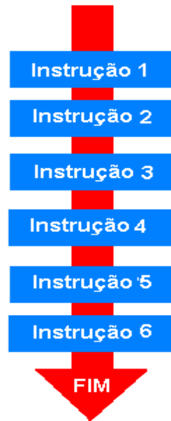
Figura 20. Forma de execução linear
