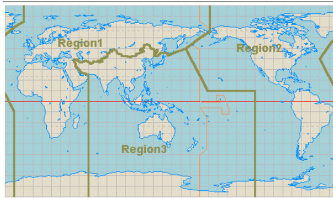
Figura 12: Regulamentação para sistemas de Radiofrequência definidas pelo ITU. Fonte: Travassos (2009)
