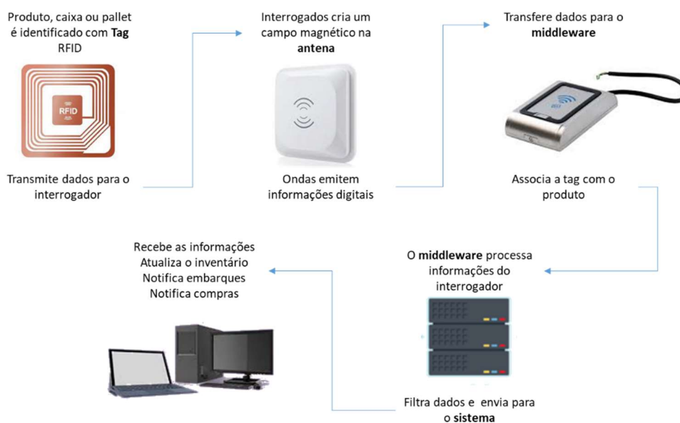
Figura 8. Componentes do sistema RFID
