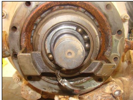
Figura 2. Falha na gaiola do rolamento rígido de esfera
