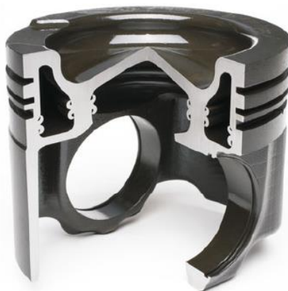
Figura 5: Pistão em aço monobloco soldado por fricção. MAHLE TopWeld (MAHLE GmbH, 2012).
