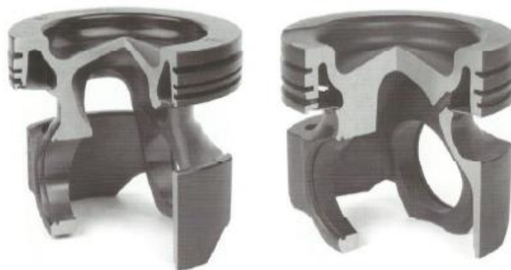
Figura 3: Pistões de aço forjados, com canal de refrigeração (YAMAWAKI, Marcio, 2013)
