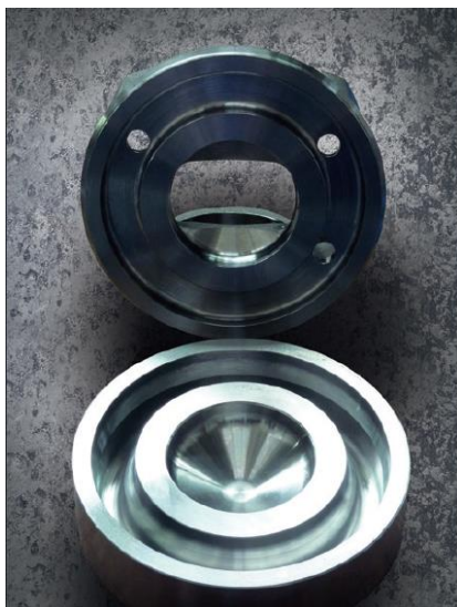
Figura 6: Duas partes de um pistão em aço da Mahle prontas para a soldagem por fricção (MAHLE News Aftermarket, 2015)
