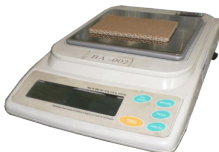
Figura 4 - Teste de gramatura
