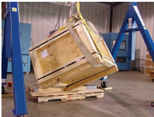
Figura 5 - Teste de impacto
