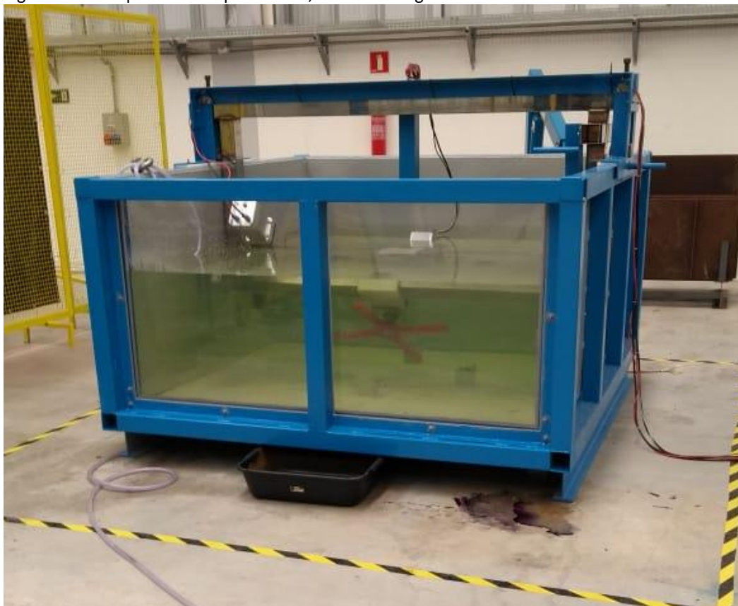
Figura 37 – Tanque utilizado para testes, simulando algumas estruturas do veículo MCCR
