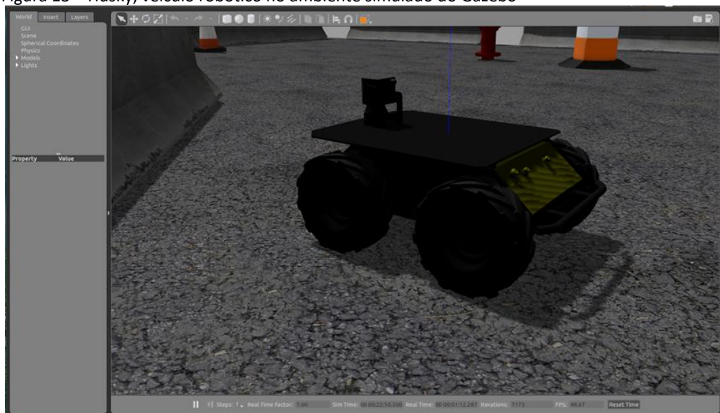
Figura 13 – Husky, veículo robótico no ambiente simulado do Gazebo
