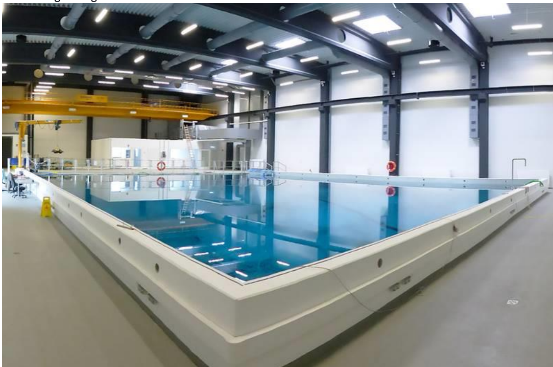
Figura 16 – Tanque para testes de robótica, localizado no DFKI. Contém capacidade de 3,5 milhões de litros de água salgada
