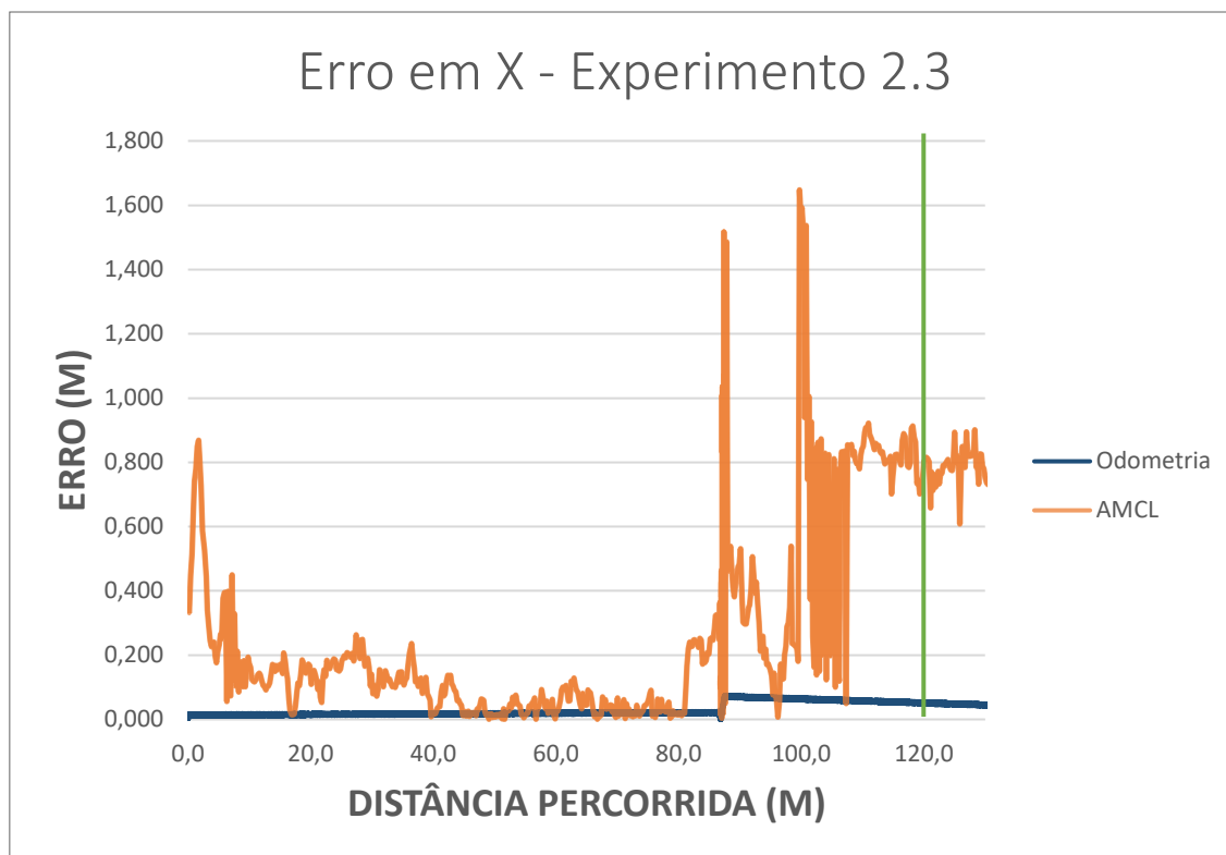
Figura 46 – Erro associado à estimação de posição no eixo X do experimento M2.3. A linha verde representa o ponto de 120m . a) Gráfico com escala do erro maior. b) Gráfico com escala do erro menor.
