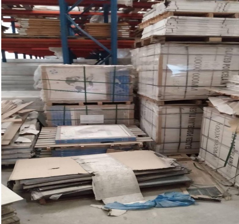
Figura 30. Más condições de armazenamento - parte 2
