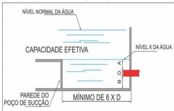
Figura L2: Tomada lateral de sucção para bomba principal
