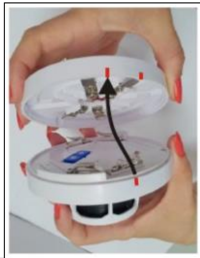
Figura H36: 1º passo de montagem do detector de fumaça
