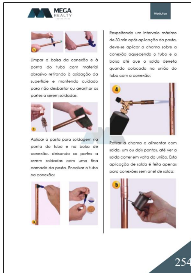
Figura 24: Procedimento executivo do Sistema Hidráulico de Incêndio
