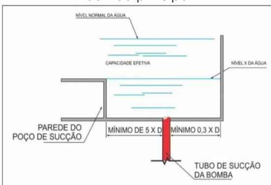
Figura L3: Tomada inferior de sucção para bomba principal
