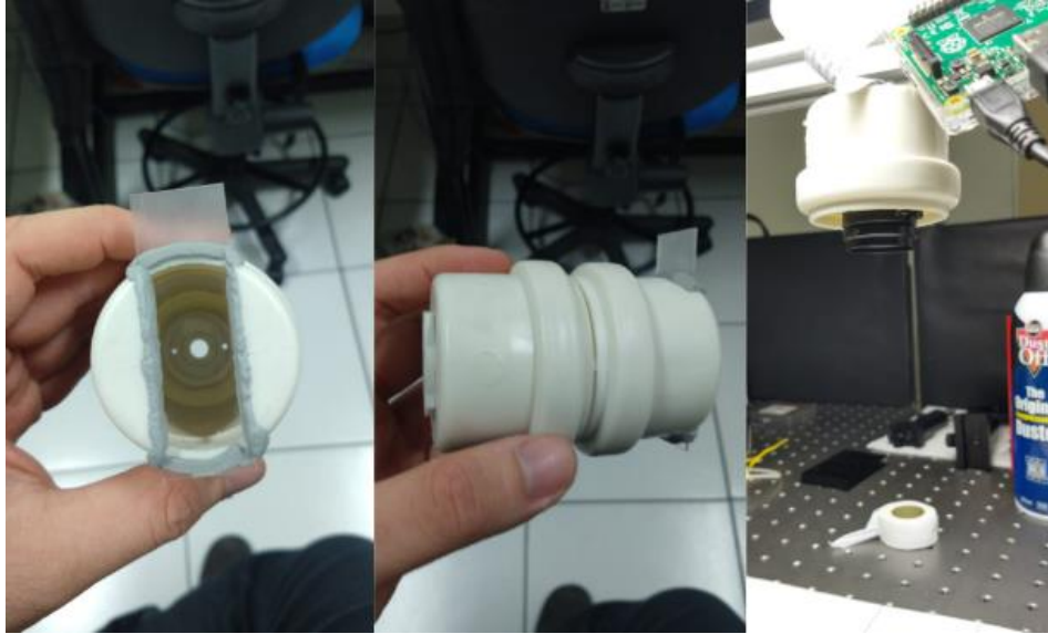
Figura 45: Encapsulamento produzido para proteção da câmera.
