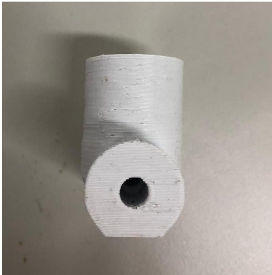
Figura 39: Nova peça 3D para acoplamento do atuador.
