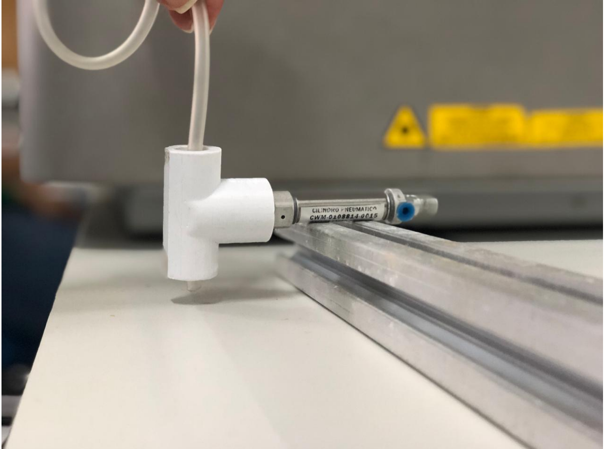
Figura 38: Montagem da peça 3D com o pistão pneumático, utilizados para testes.
