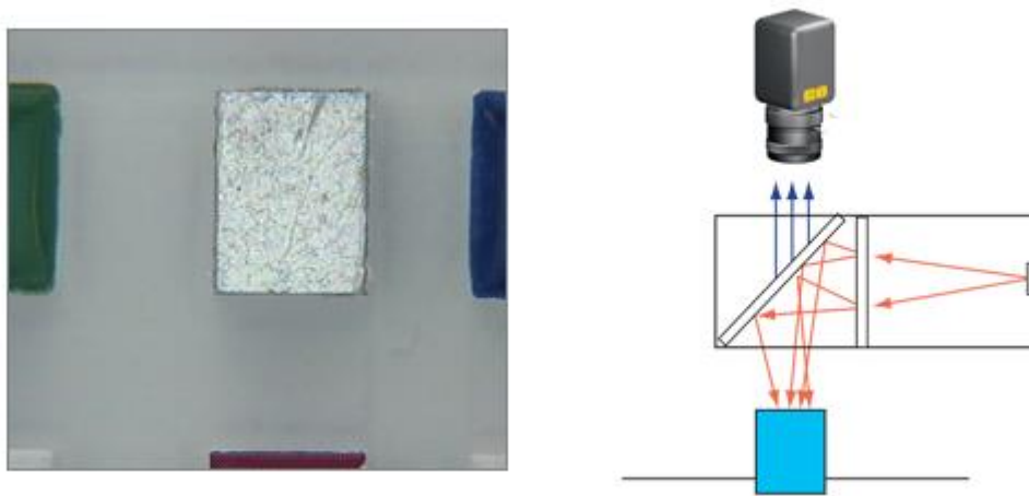
Figura 25: Sistema de iluminação difusa axial.
