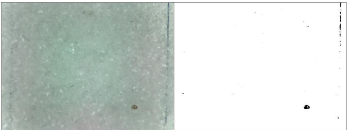
Figura 50: Aplicação de máscara sobre imagem de grãos de 1mm a 0,7mm.
