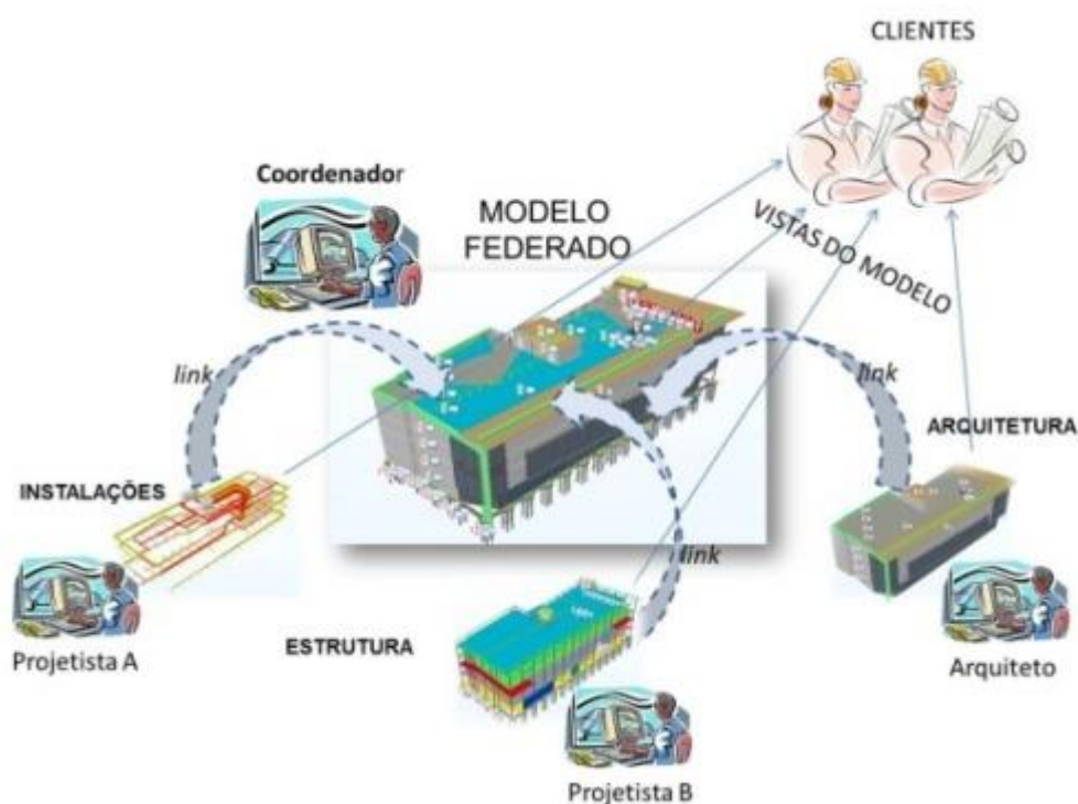
Figura 8 - Ilustração da metodologia de modelo federado
