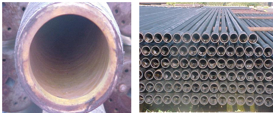
Figura 4 A e B: Tubos revestidos da coluna de produção da bomba BCS Fonte: Empresa Beta
