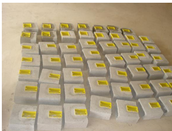
Figura 5 – Central de produção de fixação das caixas elétricas
