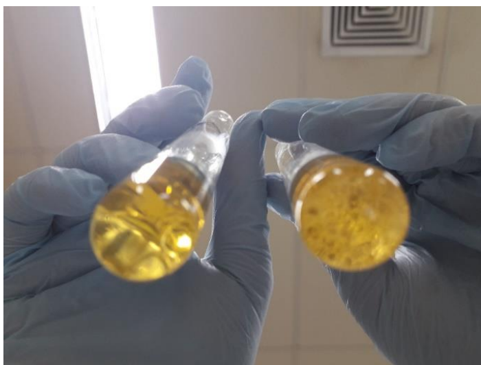
Figura 2 - À esquerda óleo e água; à direita óleo e surfactante
