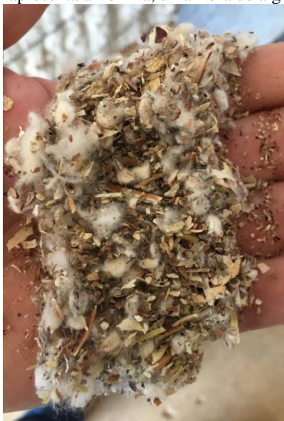
Figura 25. Material retirado nos Batedores e HLST no processo de beneficiamento de algodão da unidade investigada. O material apresenta a fibrilha, uma fibra de algodão de baixa qualidade.
