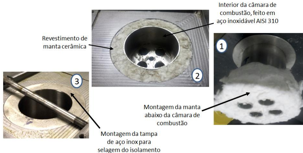
Figura 9 - Detalhe da montagem da câmara de combustão com o revestimento em manta cerâmica.
