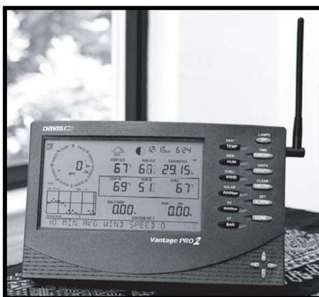
**Figura 1:** IHM da estação meteorológica Vantage Pro2 - DAVIS INSTRUMENTS.
