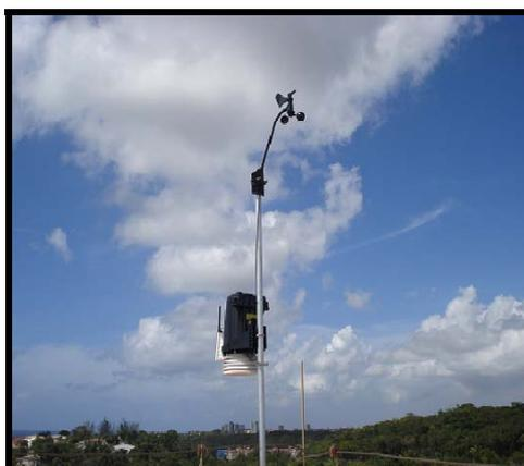
**Figura 2:** Torre instrumentada da estação meteorológica Vantage Pro2 - DAVIS INSTRUMENTS.
