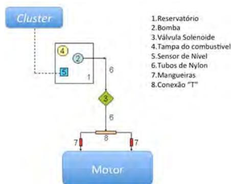
Figura 2 – Diagrama do Sistema de Partida a Frio com Tanque de Gasolina (Adaptado) [10]
