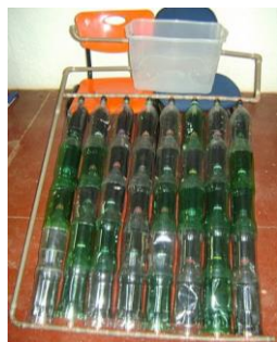
Sistema de aquecimento de água com garrafas PET
