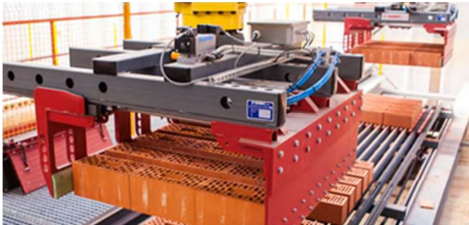
Figura 2. Esteira transportadora e ferramenta de manipulação tipo garra. Fonte: SABO, 2015
