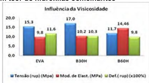
Gráfico 2. Influência da viscosidade em resinas com teor de hidroxilas semelhantes
