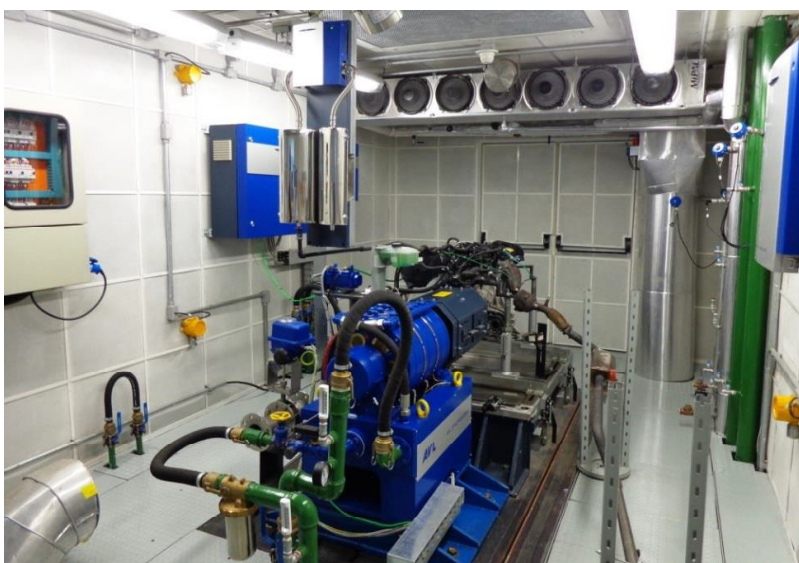
Figura 26 - Laboratório de Dinamômetros de motores do SENAI CIMATEC.
