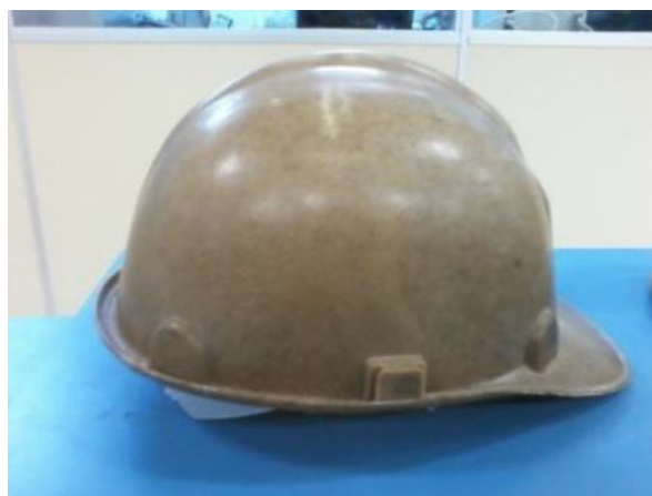
Figura 1: Capacete de obra feito a partir do compósito de polipropileno e fibra de sisal.
