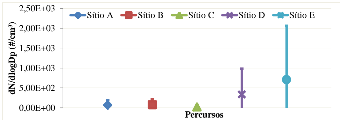
Figura 1. Concentração de partículas com diâmetro de 100 nm com janelas abertas, “SingleScan Mode”.
