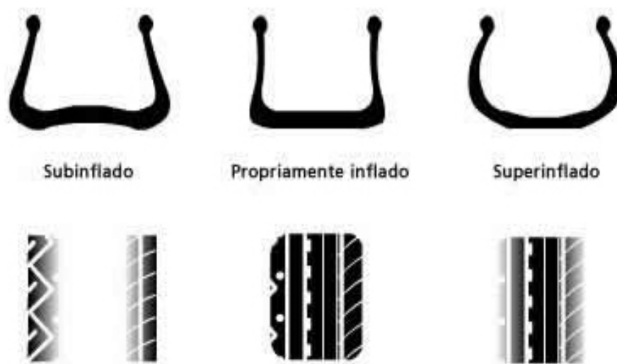
Figura 2.22: Diferentes configurações de calibração de pneu e seus efeitos no contato com o solo. Fonte: OBRINGER
