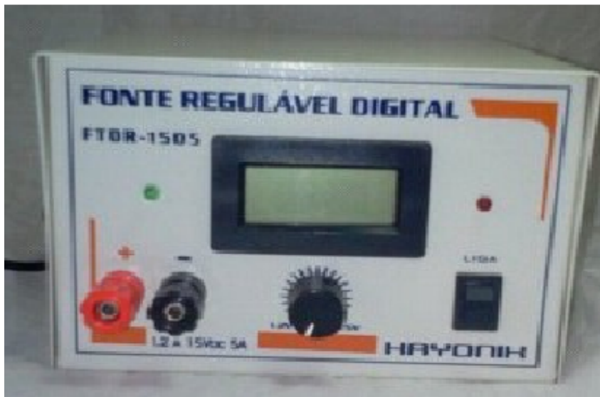
Figura 4.1: Fonte ajustável de 1,2 a 15 volts .
