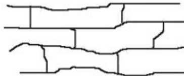
Figura 3: Representação simplificada de cadeias poliméricas reticuladas.
