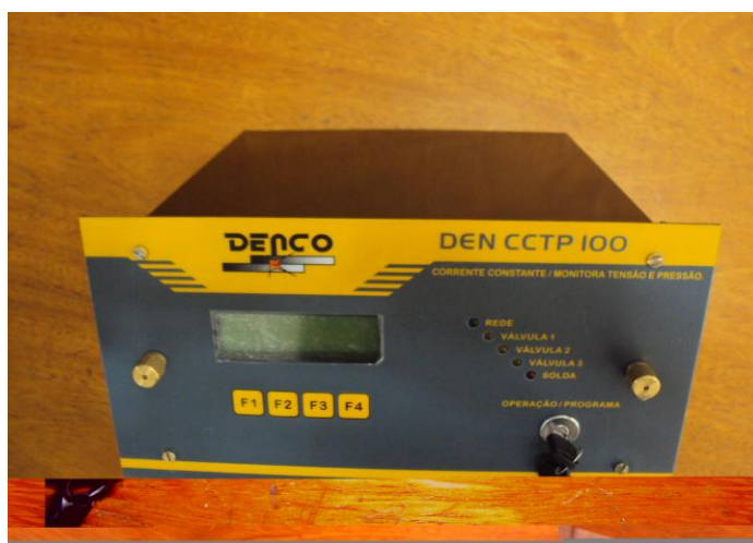
Figura 5.8a – Controlador de soldagem de corrente constante para equipamento de soldagem monofásico por solda de resistência
