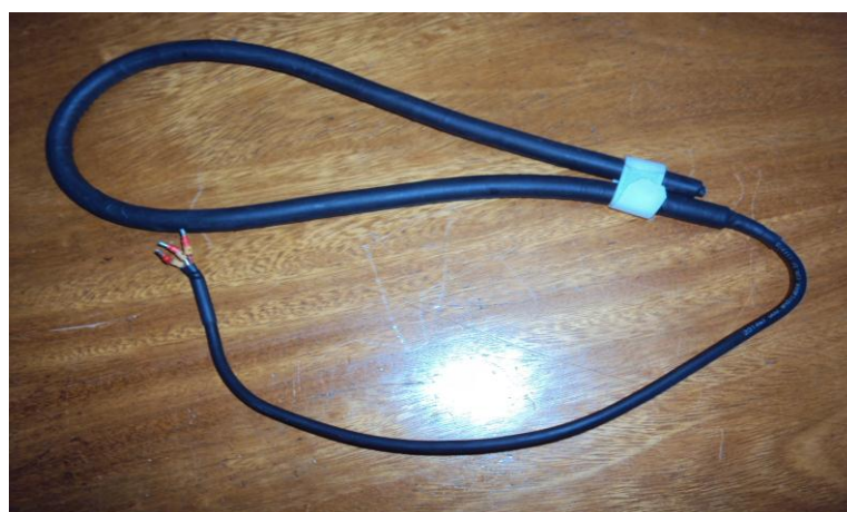
Figura 5.9 – Transformador de corrente de medição em núcleo de ar da fonte de soldagem do controlador CCPT 100
