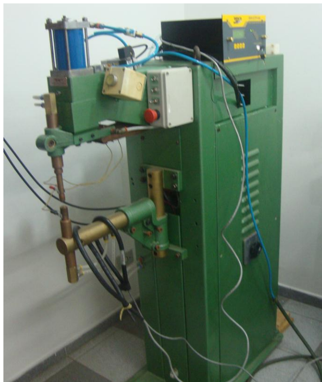
Figura 5.7 – Fonte de soldagem de 45kVA adaptada para a medição da resistência dinâmica no primário e secundário simultaneamente
