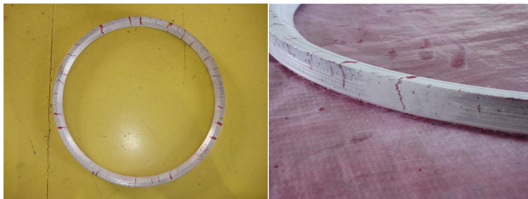
Figura 40 – Região 1 após corte por usinagem em Mandriladora.
