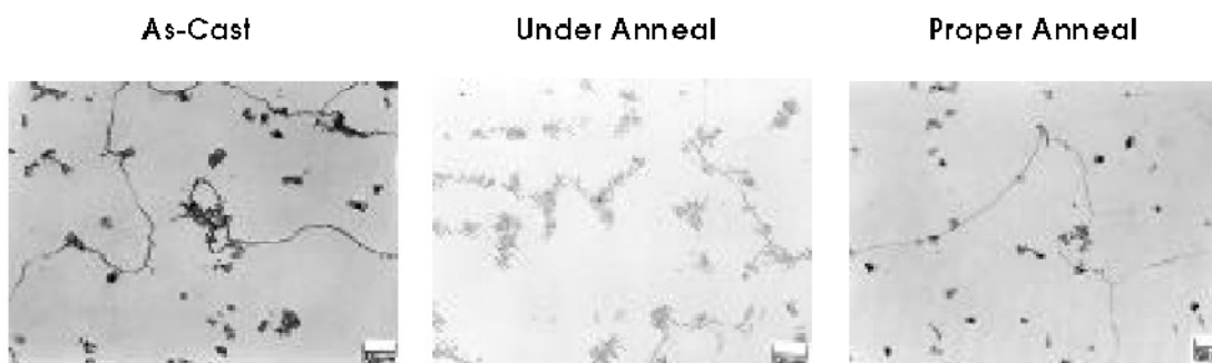
Figura 16. Estado microestrutural na condição como fundida, em recozimento e após um recozimento e resfriamento adequado (HAYNES, 1992).
