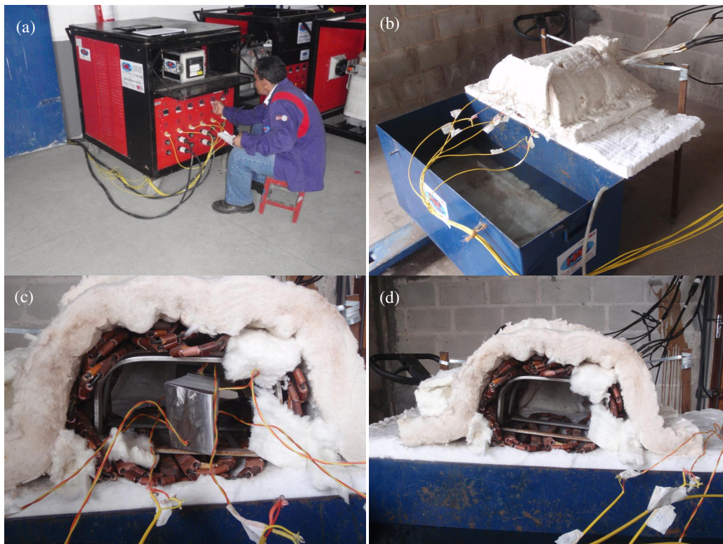
Figura 50 – (a) “Power Machine”. (b) Forno, tanque com água renovável, cabeamento de alimentação das duas resistências e cabeamento de leitura dos seis termopares. (c) Estrutura do forno (barras de aço inoxidável envolvidos por resistências e manta cerâmica com amostra dentro). (d) Idem c sem amostra dentro.
