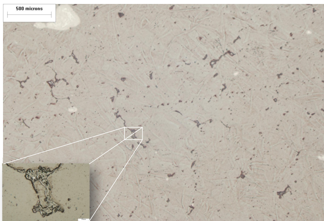
Figura 101 – Réplica metalográfica do corte transversal da região 2, a 20 mm de profundidade da borda em contato com o licor ácido, após o tratamento térmico de recozimento de solubilização. Presença de precipitados. Aumento de 25x e detalhe com aumento de 500x.
