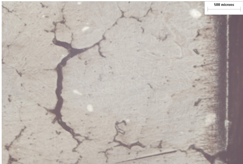
Figura 96 – Réplica metalográfica do corte transversal da região 2, lado em contato com o licor ácido, após o tratamento térmico de recozimento de solubilização. Superfície da amostra no lado direito da figura. Aumento de 25x.
