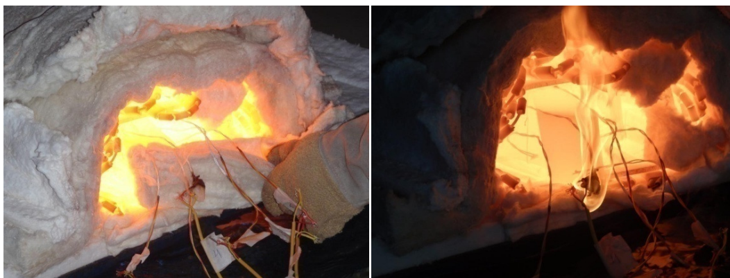
Figura 102 – Remoção da amostra da região 2 do forno de tratamento térmico.
