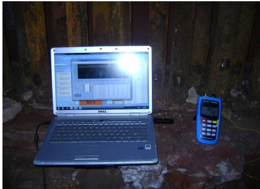
Figura 21: Foto do medidor e note book para coleta de dados de umidade
