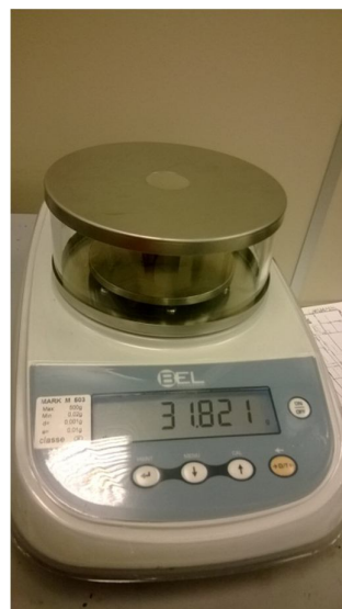
Figura 28 - Balança de precisão pesando um dos corpos de prova.
