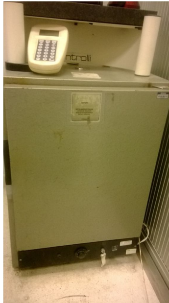
Figura 29 - Estufa utilizada na secagem dos eletrodos peça e ferramenta.
