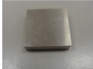
Figura 27 - Corpo de prova de INCONEL 718, antes da usinagem.
