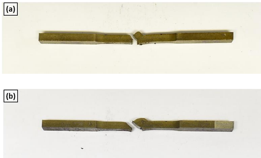
Figura 36. Corpos de prova da amostra 7 (a) e amostra 11 (b) após o ensaio de tração, mostrando que nos corpos de prova onde existia falta de penetração tivemos a fratura acontecendo entre a zona fundida e a ZTA.
