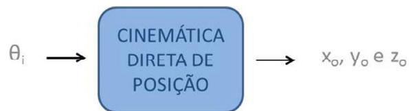
Figura 5 Esquema da Cinemática Direta
