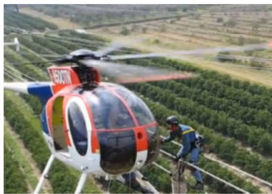
Figura 2 - Inspeção de linhas de transmissão de energia feita por aeronaves tripuladas
