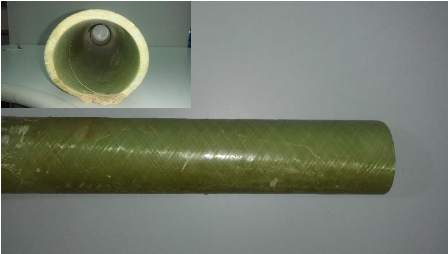
Figura 9. Parte da tubulação de fibra de vidro
