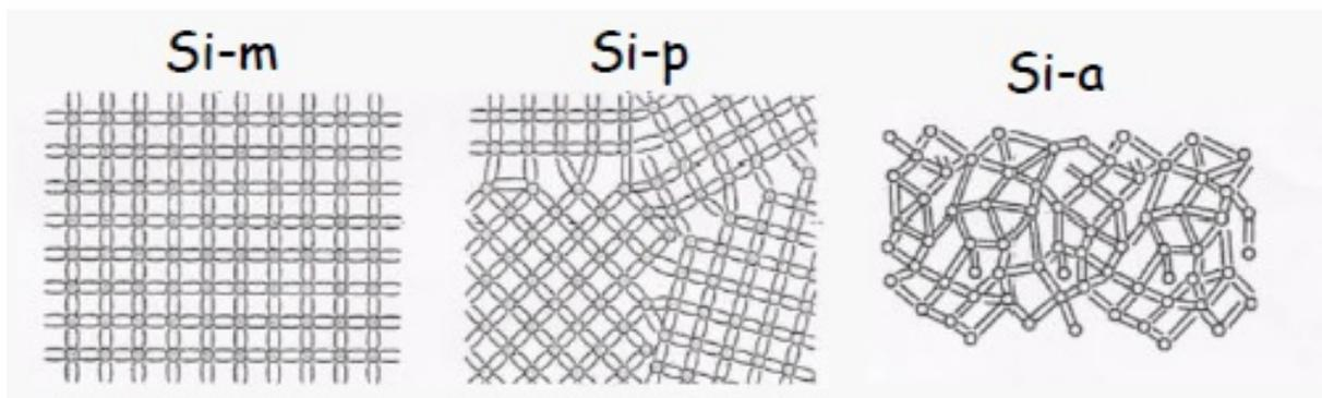
Figura 2.8: Esquema da estrutura atômica de um material monocristalino, policristalino e filme fino.
